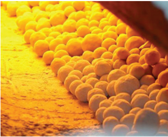
Rys. 7. Zgranulowany odpad flotacyjny w strefie kalcynacji pieca obrotowego
